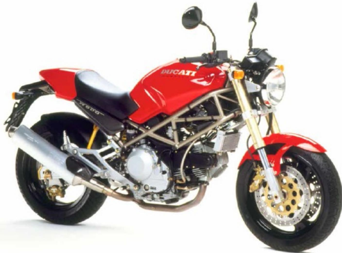
**SCHEDA TECNICA****Motore** bicilindrico a L longitudinale 4 tempi**Cilindrata** 904 cmc**Alesaggio e corsa** 92x68x2 mm**Alimentazione** 2 carburatori Mikuni BDST 38**Cambio** 6 marce**Rapporto di compressione** 9,2:1**Potenza massima** 73,4 CV a 6.750 giri**Peso a vuoto** 184 kg**Prestazioni** 190 km/h**La prima naked: da allora niente sarà più come prima**
